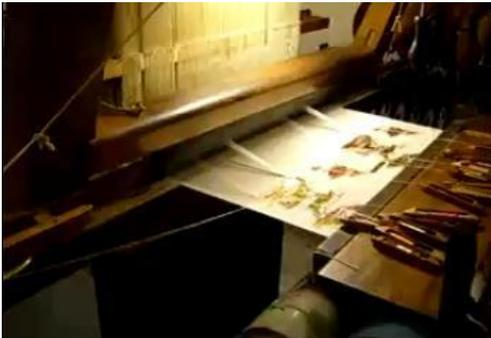
**Figura 1:Telaio jacquard meccanico a schede o a nastro perforati**
